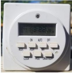
Para programar el reloj del cronómetro, mantener apretado el botón “clock” (reloj) y hacer los ajustes necesarios usando los botones “week” (semana), “hour” (hora), y “minute” (minuto).
