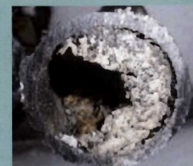
Tubería tapada Ocasional por la eliminación indebida de grasas
